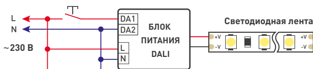
Рис. 1. Схема подключения при использовании внешней кнопки (Push Dim).
